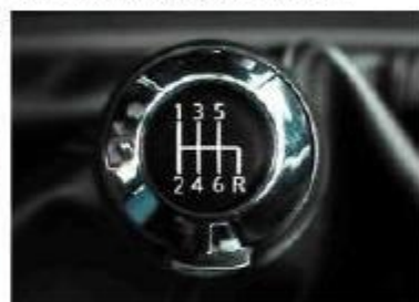
Řazení má dlouhé dráhy a není zcela přesné, do řadicí páky se přenášejí vibrace od motoru.
