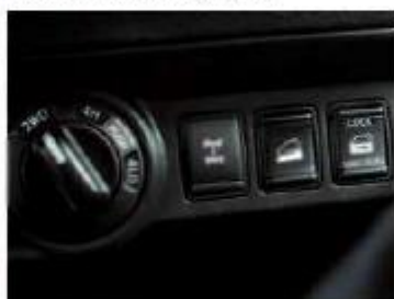
Na silnici stačí zadní pohon, v terénu již přijde vhod 4x4, redukce a závěr zadního diferenciálu.
